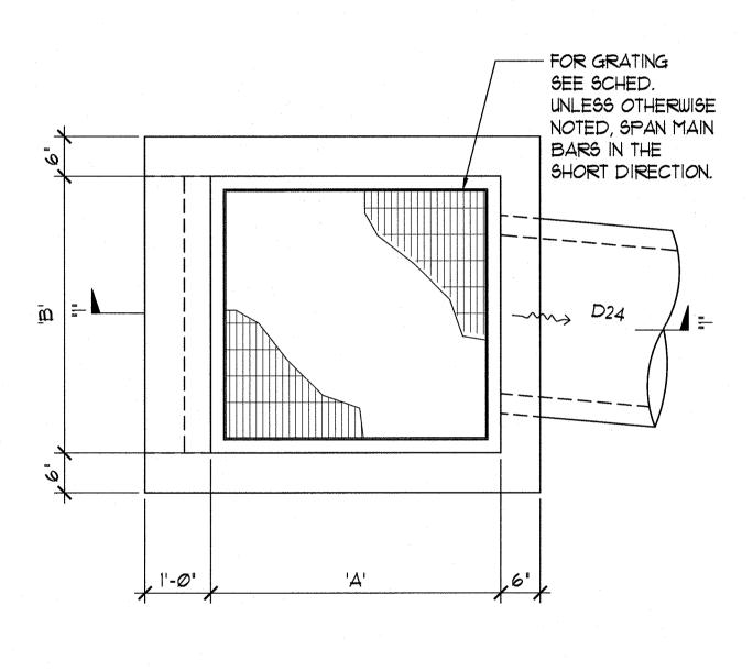
GRATING SHALL BE HOT DIP GALVANIZED PLAN
