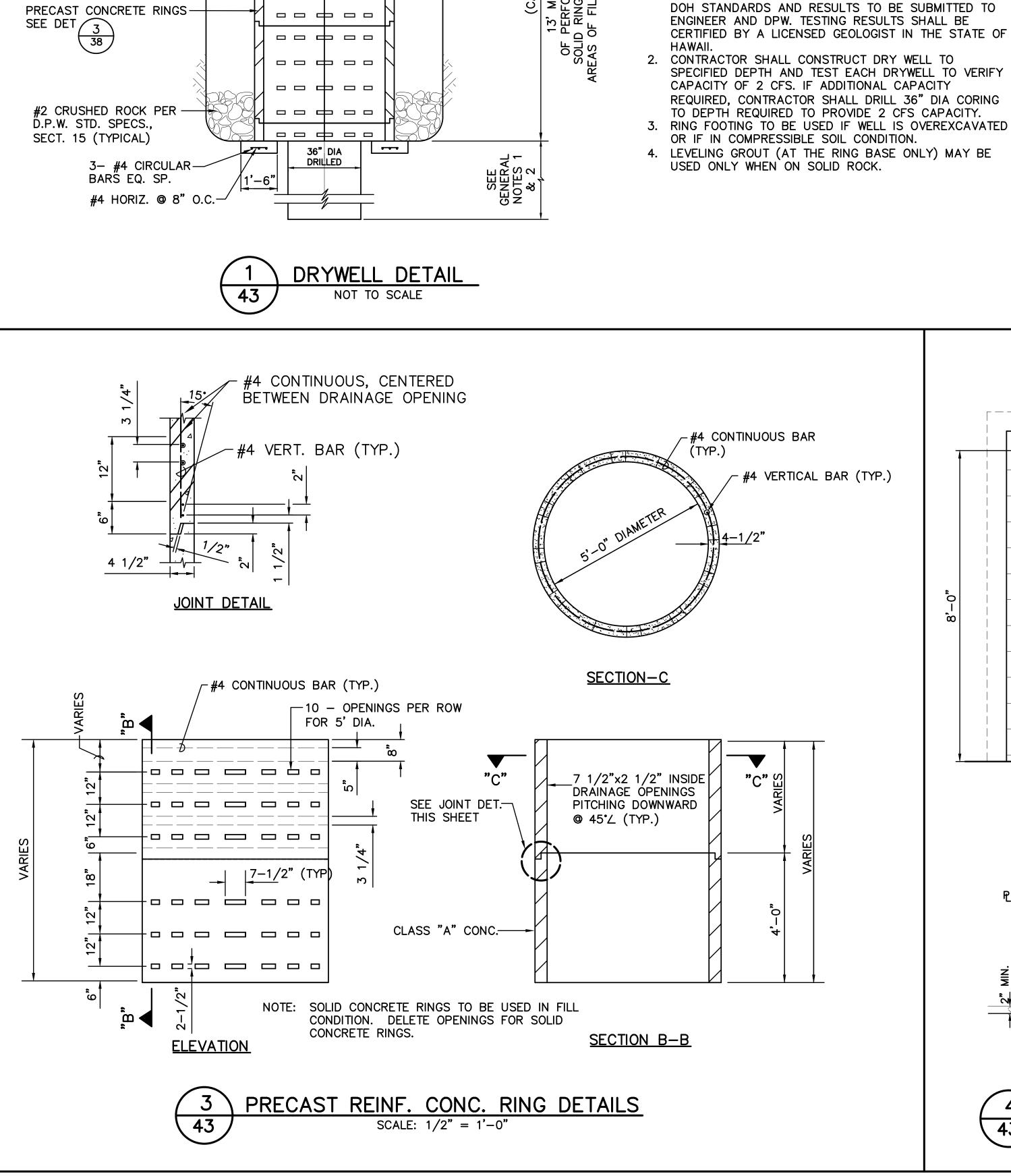
1. CONTRACTOR SHALL TEST DRAINAGE CAPACITY OF
