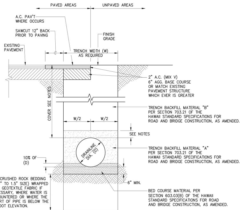
TYPICAL TRENCH RESTORATION DETAIL FOR DRAINLINE
